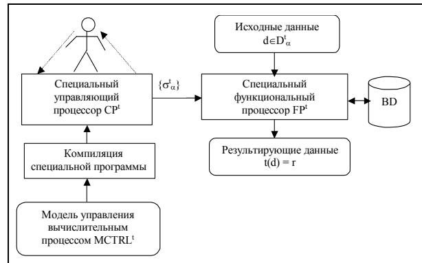
**Рисунок 6. Специальный управляющий процессор**
