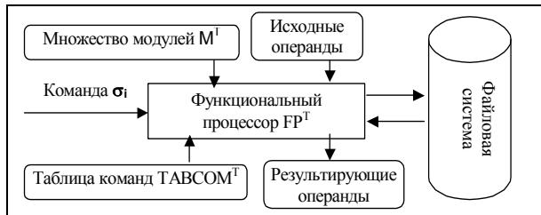
**Рисунок 1. Функциональный процессор программного комплекса**
