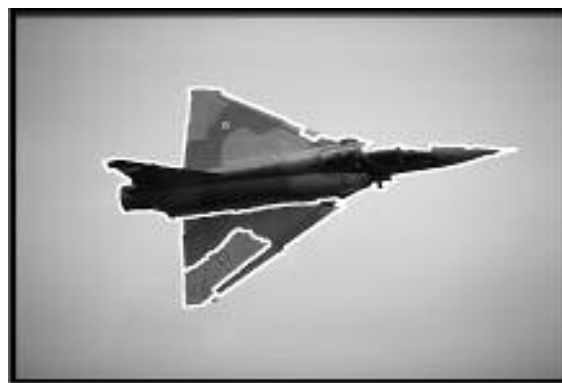
Рисунок 6. Наиболее сильные границы выделенные сегментацией на изображении самолета
