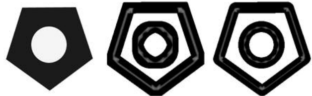
Рисунок 4. Модельное изображение (слева) и негативные R -изображения построенные рамками с различной геометрией (в центре – квадратная, справа - круглая)
